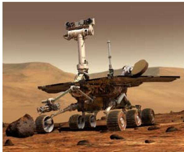
SOLIMIDE在火星中的应用：该泡沫材料被用于漫游者号火星探测器中。在国际太空站(ISS)、西科斯基直升机以及许多其他应用领域中，这种泡沫被用作隔热和隔音材料。
